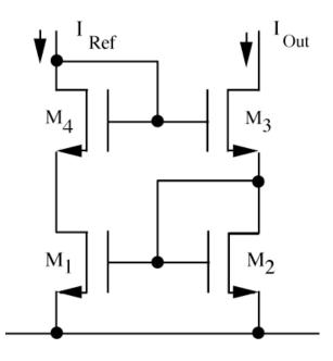
$$V_{DS1} = V_{GS3} + V_{DS2} - V_{GS4}$$
