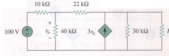
Figura 1: Circuito para equivalente de Thevenin.
