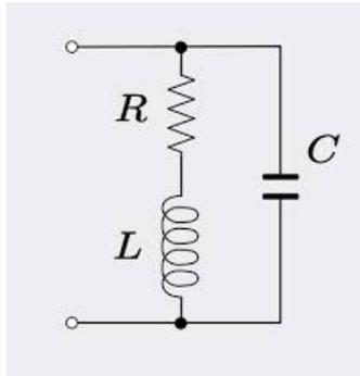
Figura 1: Circuito para correccion de factor de potencia.
