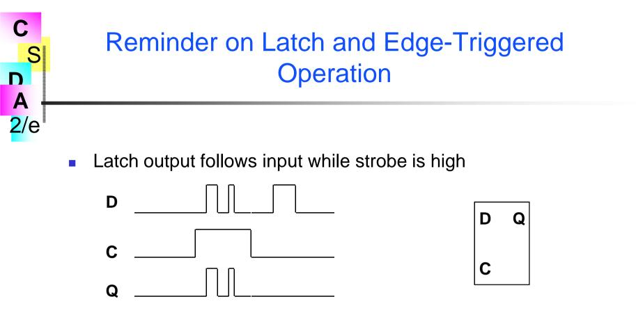
• Edge triggering samples input at edge time
