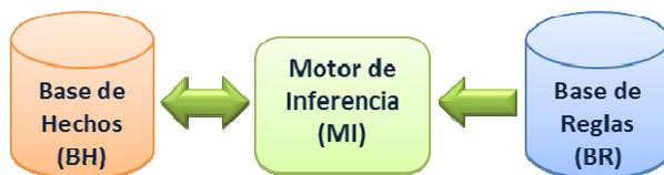
Figura 1. Arquitectura de un sistema de producción en CLIPS
